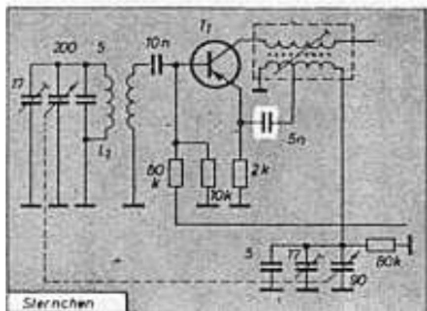
Bei einem anderen Gerät schwang ebenfalls der Oszillator nicht. Als Fehlerursache wurde der 5-nF-Rückkopplungskondensator festgestellt.
